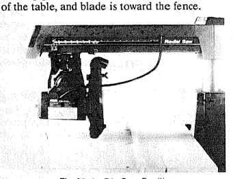
Fig. 96 In-Rip Saw Position
